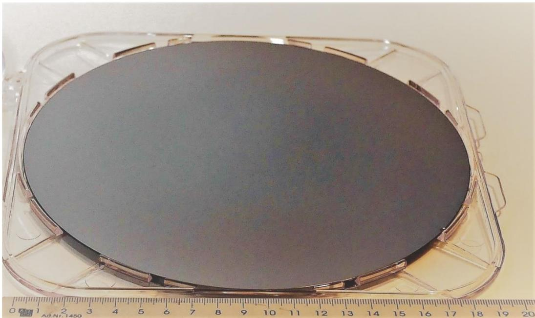
图 1: 200mm 用于 HPE 市场的硅基氮化镓外延片样品，基于 ALLOS 的技术，由 AZUR SPACE 供货
